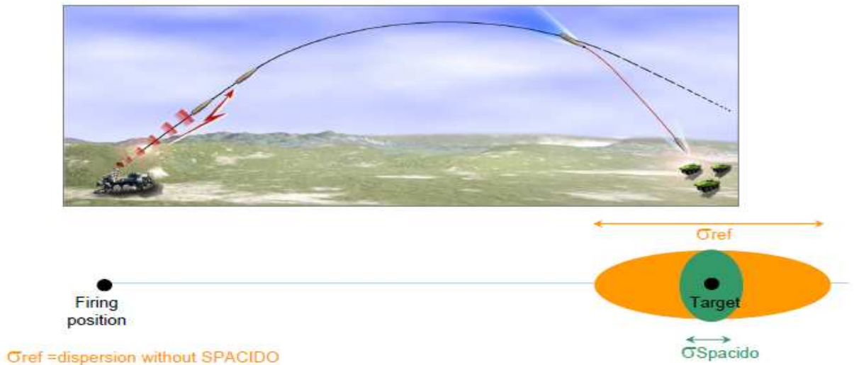
Fig 28: La CCF SPACIDO utiliza un sistema de guiado “beam guidance” y sistema de control “drag brake”, con correcciones en 1-D.
