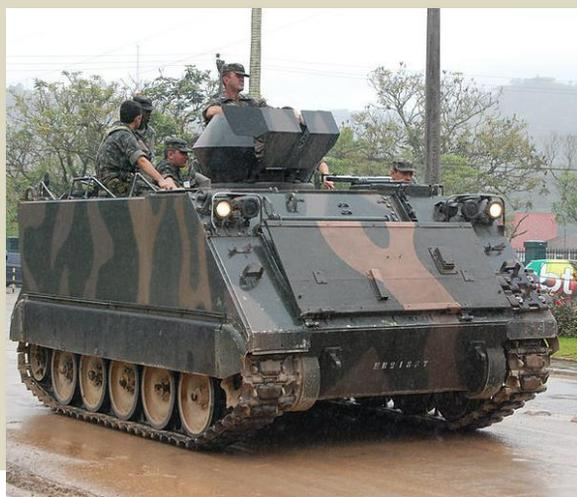
**La modernización del M113B incluye la instalación de un nuevo motor y mejoras en la suspensión, el diferencial y el sistema de refrigeración.**
