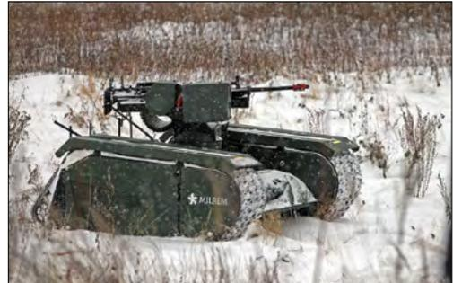
Su autonomía es de ocho horas con las baterías y un tanque de combustible lleno. Con dimensiones de 2,5 metros de largo, 2 metros de ancho y 0,6 metros de alto, esta plataforma tiene un peso de 700 kilos con capacidad de carga igual a su peso. Su velocidad máxima es de 25-35 kilómetros por hora.
