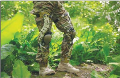
obtener electricidad. Algunos de los sistemas en estudio para aplicaciones militares, como el mostrado en la Figura 4 toman energía del movimiento de la articulación de la rodilla, convirtiendo el movimiento rotacional de la misma en suficiente electricidad para cargar cuatro teléfonos inteligentes en una hora<sup>68</sup>. Actualmente está siendo evaluado operacionalmente por las Fuerzas Armadas de Estados Unidos.
