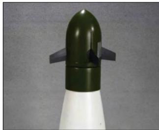
sus frenos son desplegados o recogidos, no pueden volver a modificar su posición, es decir sólo realizan una sola corrección de la trayectoria. Por otro lado, están los que sí lo pueden realizar y van actualizando su posición a través de sucesivas correcciones, siempre en sentido longitudinal.
